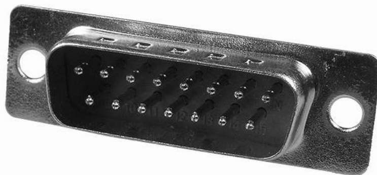
Рисунок 77. Штекер DB-15M, подключаемый к PERCo T-04.
