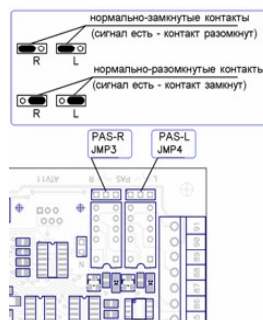
Рисунок 93. Перемычки JMP3 и JMP4 контроллера ОМА 264MC1.
