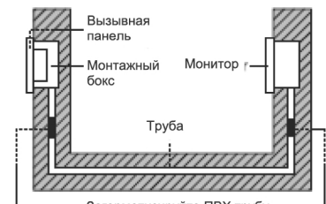
Загерметизируйте ПВХ трубу для кабеля между монитором и панелью, чтобы избежать циркуляции воздуха в ней.
