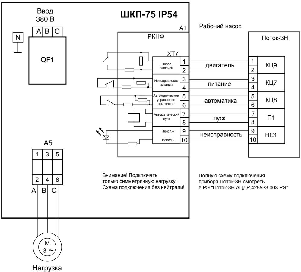
**Рисунок 3.** Схема электрическая подключения шкафа при эксплуатации
